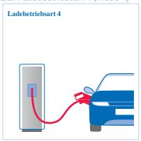
Ladebetriebsart 4 ist für das Laden mit Gleichstrom (DC Laden) an fest installierten Ladestationen vorgesehen. Das Ladekabel ist immer fest an den Ladestationen angeschlossen. Im Gegensatz zu den anderen Ladebetriebsarten ist bei dieser das Ladegerät, welches auch die Sicherheitsfunktionalitäten umfasst, in der Ladestation integriert. Die Kommunikation zwischen Ladestation und Fahrzeug erfolgt über das Ladekabel. Darüber hinaus erfolgt die Verriegelung des Steckverbinders.
