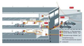
Zusätzlich zu dem Schutz der Energieversorgung ist die Datenübertragung für die Erfassung der Verbrauchsdaten zu schützen. Der informationstechnische Anschluss ist, in Analogie zum Energieanschluss, mit SPD Type 1 (D1 und C2) oder SPD Type 2 (D1 und C2) vorzunehmen.
