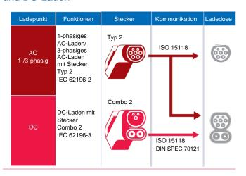
Es ist zu berücksichtigen, dass nicht von allen Ladestationen und nicht von allen Fahrzeugen alle oben beschriebenen Möglichkeiten unterstützt werden. DC-Ladeströme oberhalb von 200 A
