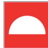
F07 Mittel und Geräte zur Brandbekämpfung
